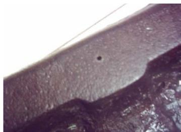
Agujero N° 2:  $\varnothing$  1.5 mm en el lateral del Hongo, realizado a 21 mm de profundidad y a 15 mm de la superficie de rodadura
