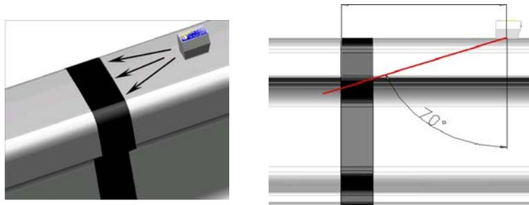
Realizado con un solapamiento del 10% entre pasadas, apoyando el transductor como indica la figura, partiendo desde el cordón hasta una distancia de 50 mm, y a ambos lados de las caras de fusión.
