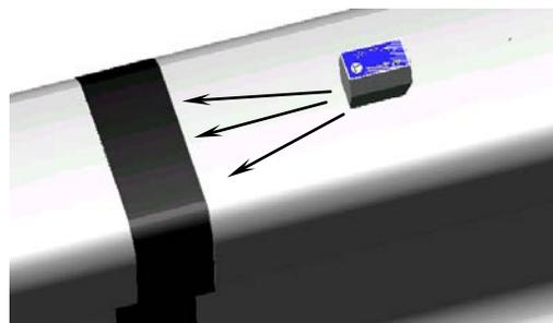
Se prevé en la exploración manual, la orientación del transductor hacia los enlaces.
